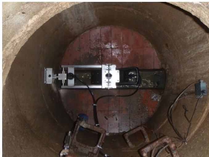
Abb. 1: Berührungslose Sensorik im Kanal
